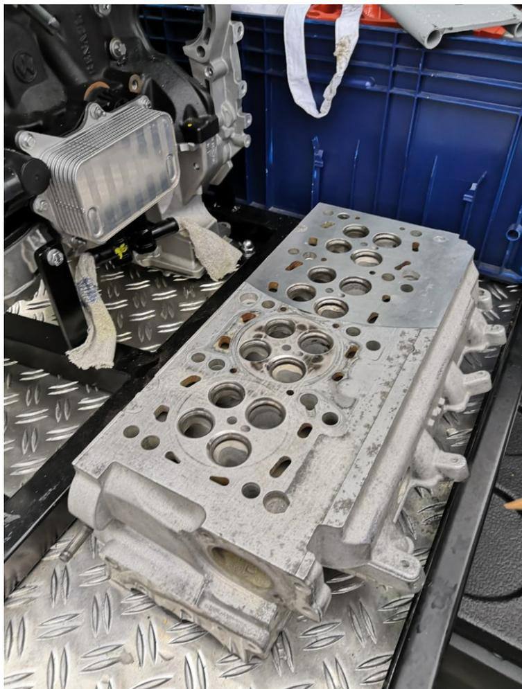
*Avec son pick-up de démonstration, Elring peut souligner aisément la différence flagrante entre une rectification de culasse à la main, à l'ancienne, et une rectification à l'aide d'une machine dédiée.*
