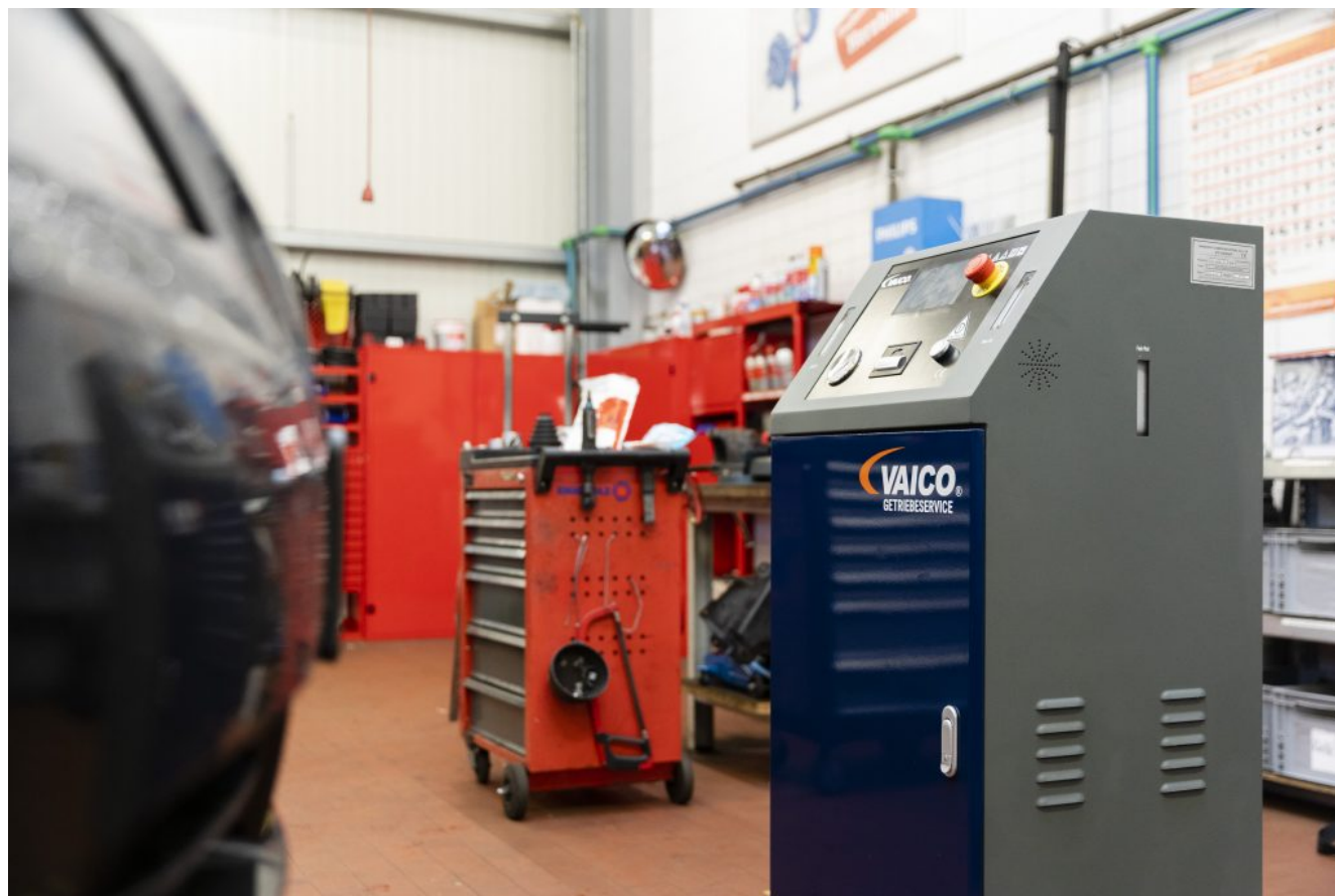
La machine Vaico destinée à vidanger les boîtes de vitesses automatiques.
